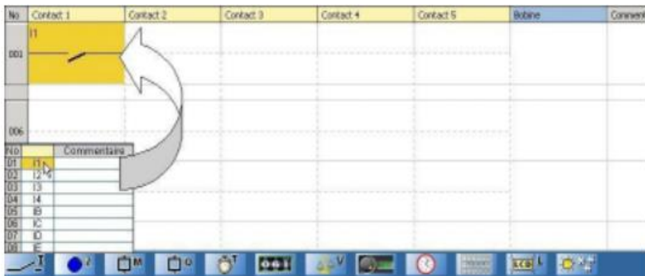
Fig.5.15.Placement du contact a l'interface.
