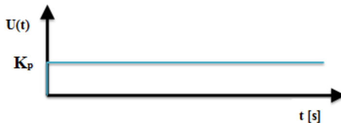
Figure III.4 : Réponse indicielle du régulateur P. [ETI14]
