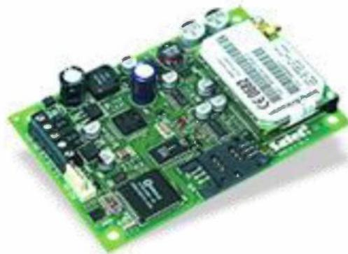
**Figure 3-35-** Exemple d'un transmetteur GSM
