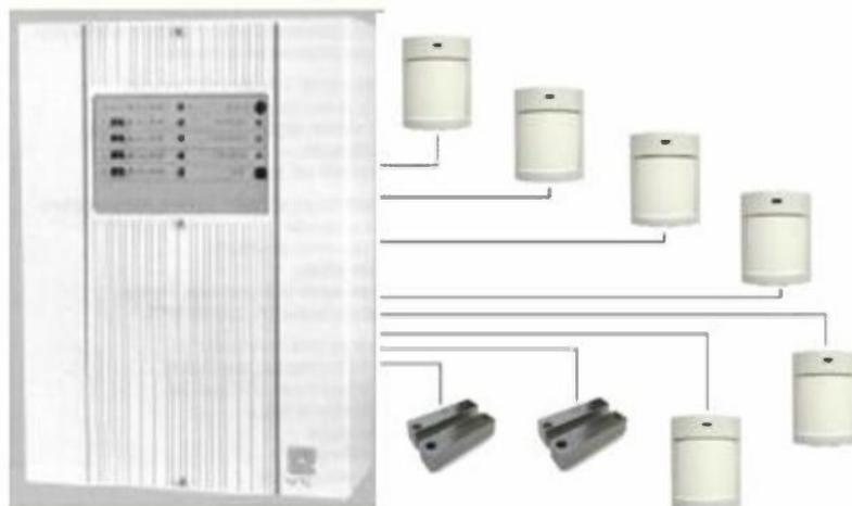
**Figure 2-11-** Représentation d'une alarme filaire [7]
