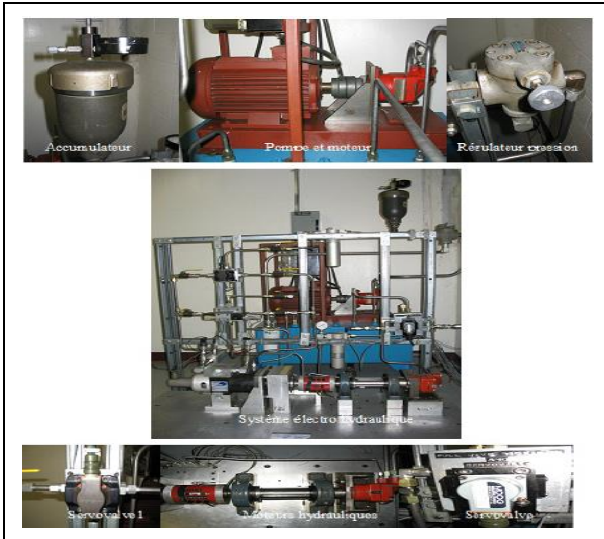
Figure II.1 Composition du système électrohydraulique du LITP
