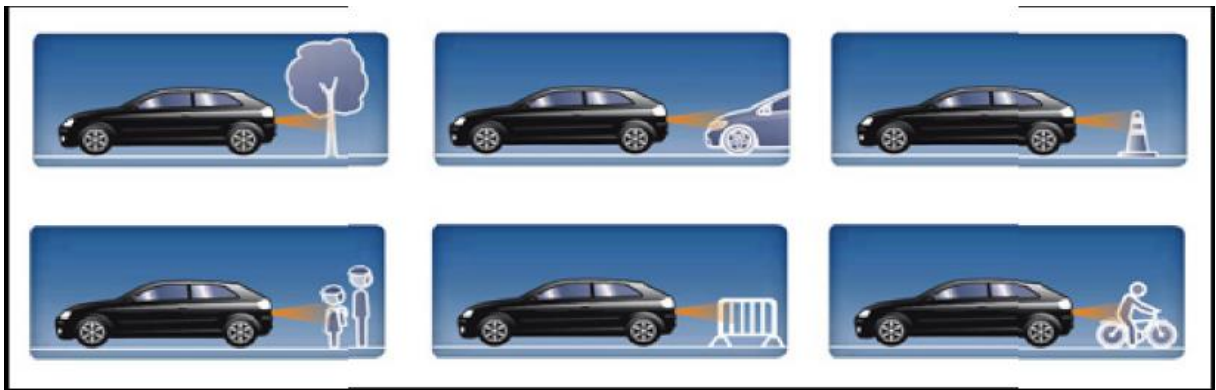
Figure II.10 : Les modes de détections de radar de recul.
