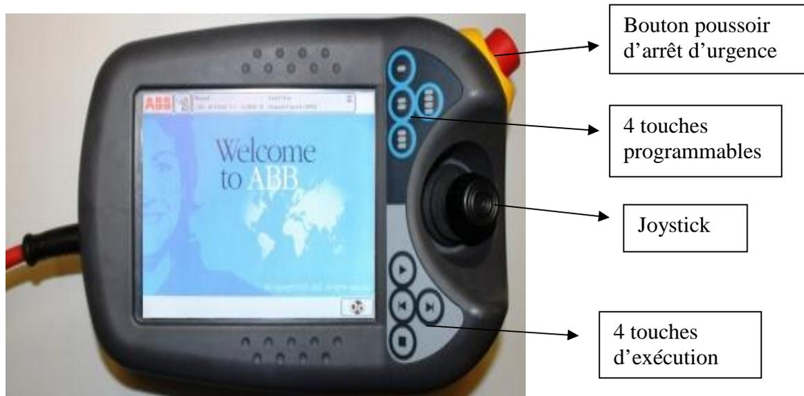
**Figure (I.29):** Boitier de commande FlexPendant de ABB.
