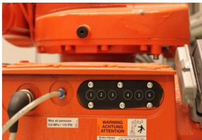
**Figure (I.26):** Bouton pour relâcher les freins à ne jamais actionner.
