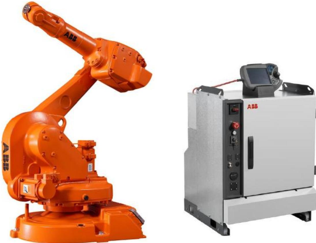
**Figure (I.22) :** Le manipulateur IRB 1600 et le contrôleur IRC5
