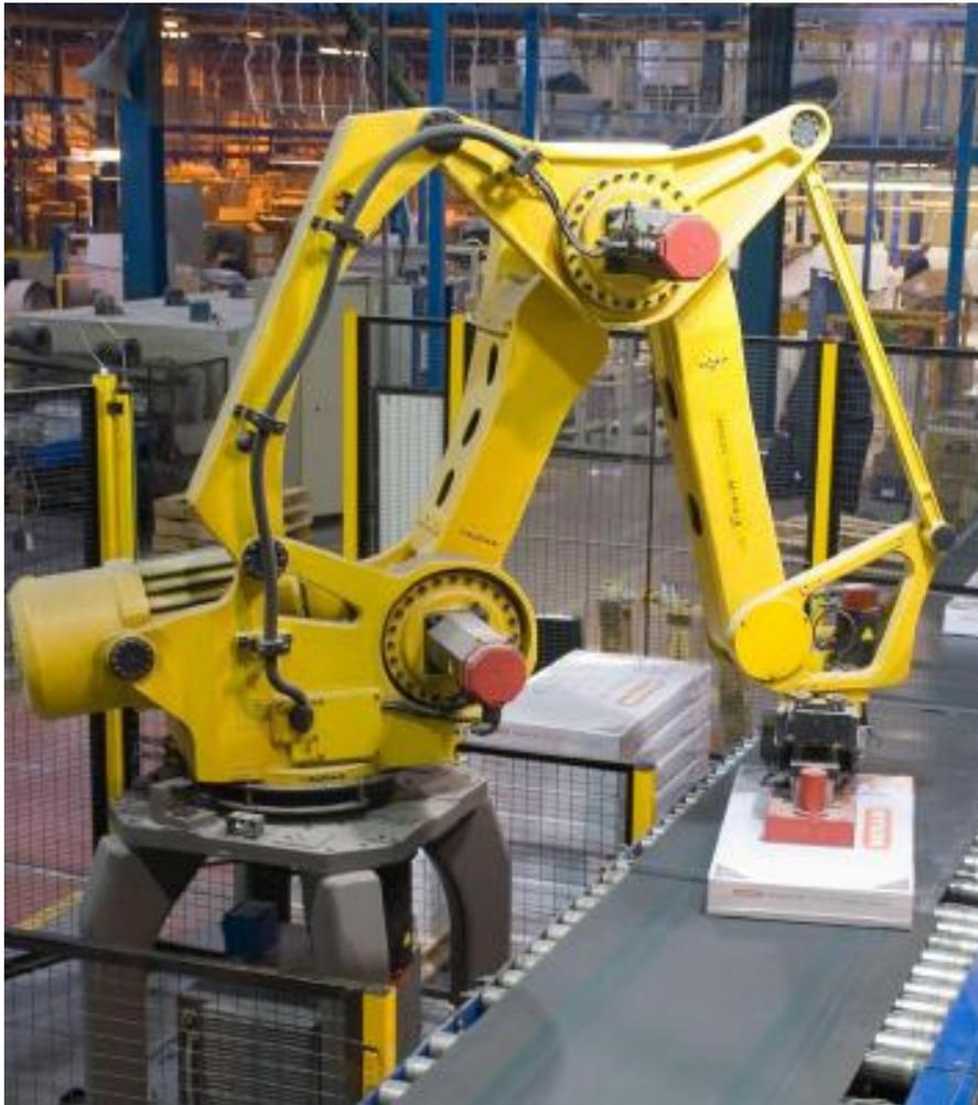
**Figure (I.10) :** Robot sériel pour palettisation à quatre ddl.
