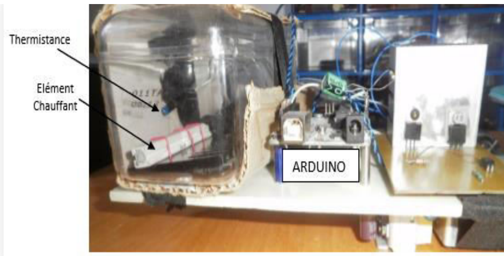
Figure I.5 : Vue de la maquette d'une chaîne d'acquisition et d'asservissement de température
