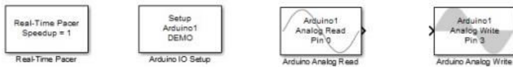
Figure II.22: Blocs d'ArduinoIO nécessaires pour la commande
