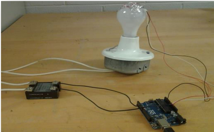
Figure I.4 : Vue de l'expérience de contrôle de température d'une ampoule.
