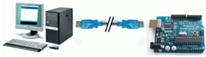
FIGURE II.26 – Téléversement du programme sous EDI vers la carte Arduino.
