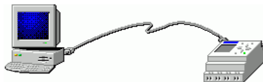
Figure 28. Transfert de l'application du module logique vers le PC
