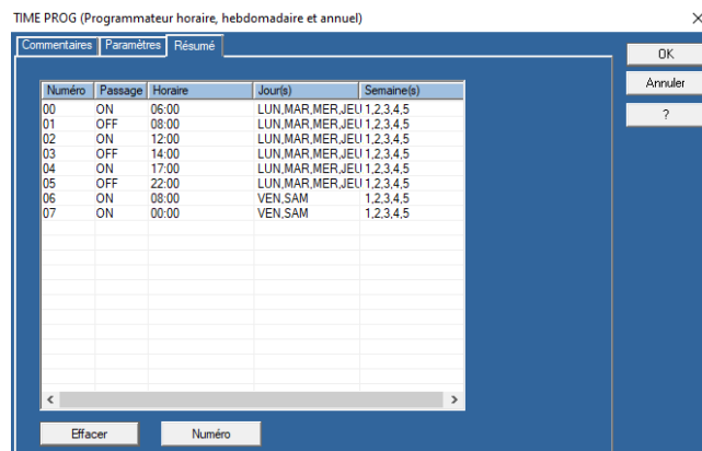
Figure 31. Paramétrage du programmeur horaire « Confort » zone 1
