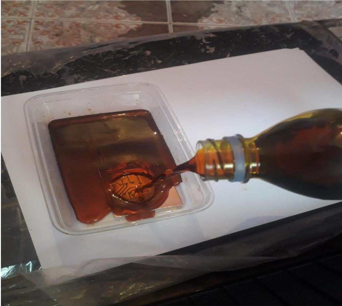
FigureIV.16.la plaque sur le réactif d'attaque
