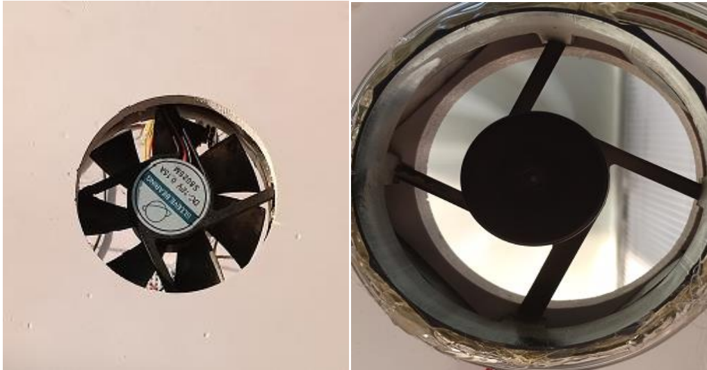
Figure II.13: Ventilateur d'ordinateur pour le système de ventilation.
