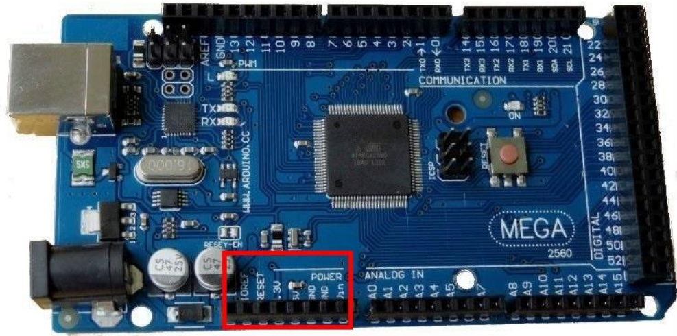
Figure A : Broche d'alimentation de la carte Arduino Méga 2560.
