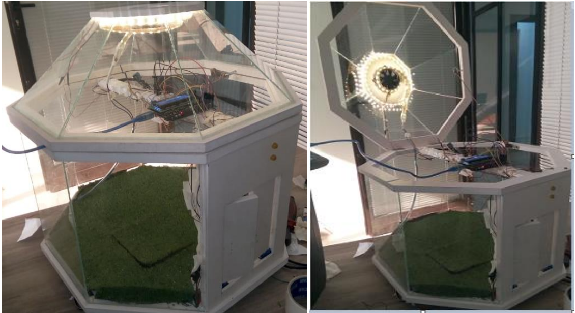
Figure III.17: Serre finale réalisée.
