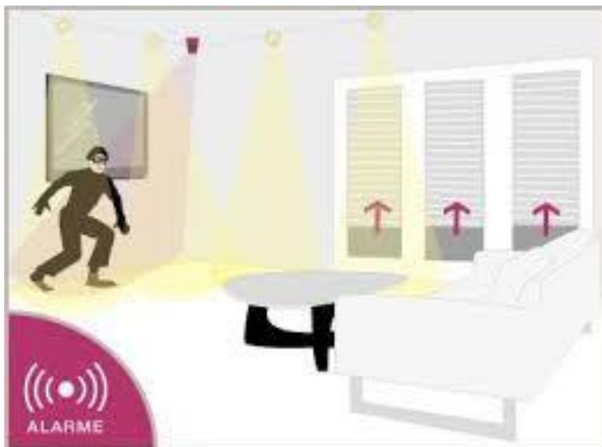
Figure I.12 détection intrusion : alarme, éclairage, volets.
