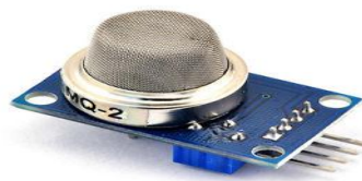
Figure III.5 Image réelle du capteur de gaz/fumée MQ-2.
