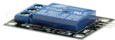
Figure III.13 Image réelle d'un relais électrique
