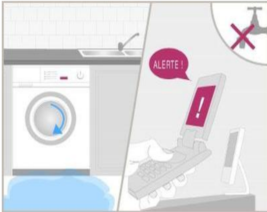
Figure I.11 Détection domestique active avec alerte à distance
