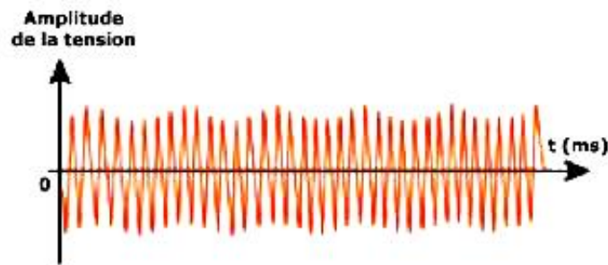
Figure (I.15) : Exemple de variation rapide de la tension
