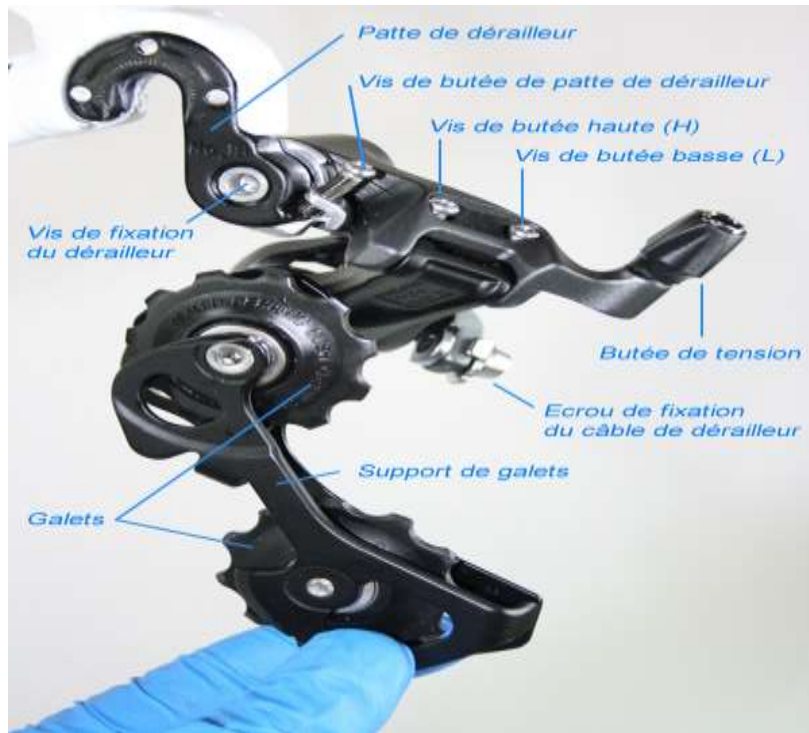
Figure 2. 7. Les composants de dérailleur arrière . [17]
