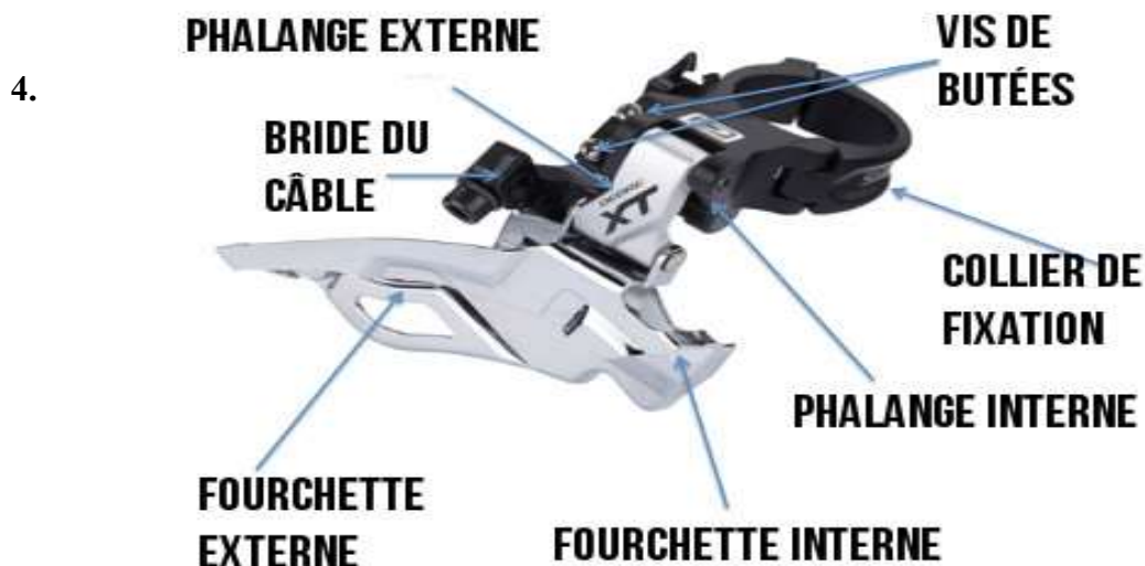
Figure 2. 8. Les composants de dérailleur avant.[18]
