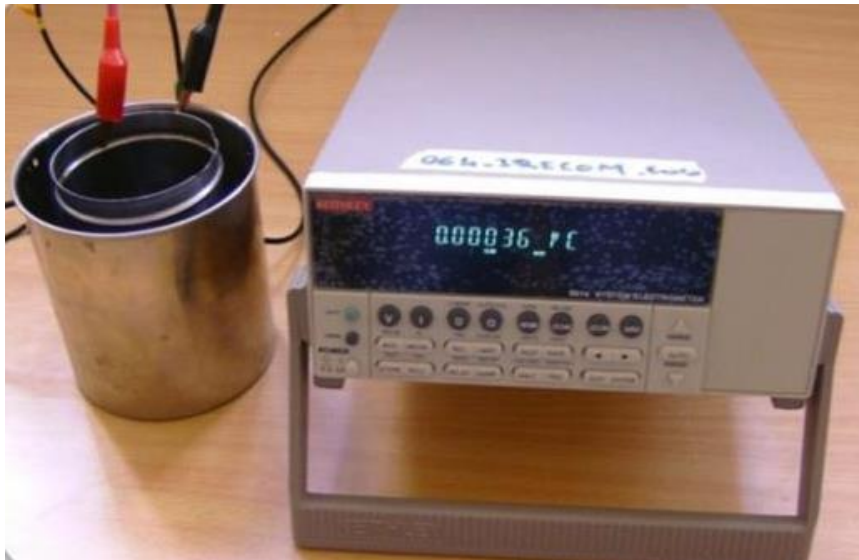
Figure 4-9 : Photographie de la cage Faraday et l'électromètre 6514.
