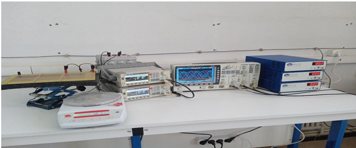
Figure 3-5- Banc Expérimental représentant l'alimentation du Convoyeur biphasé
