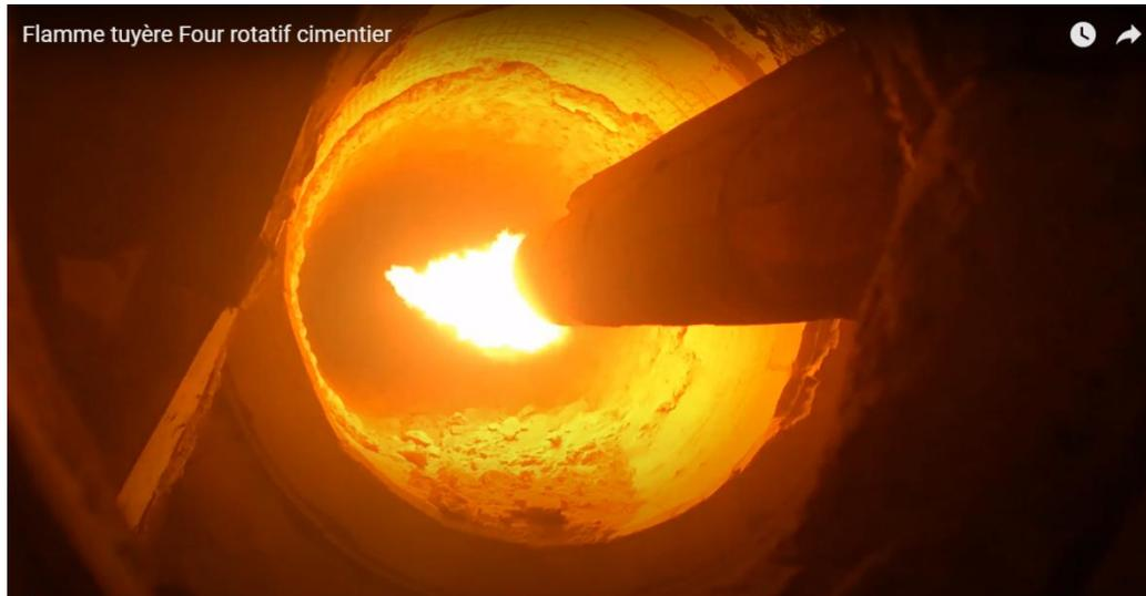
**Figure I.10 : croutage dans la partie cuisson dans le four rotatif**
