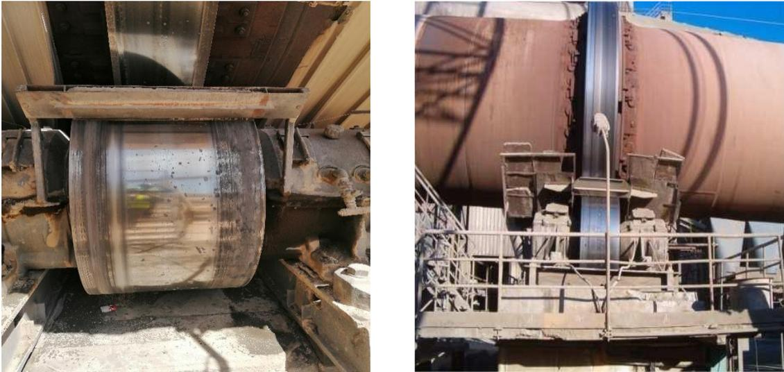
**Figure I.17 : Station des galets.**
