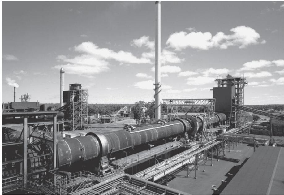
**Figure I.4 : Four rotatif de cimenterie 1**
