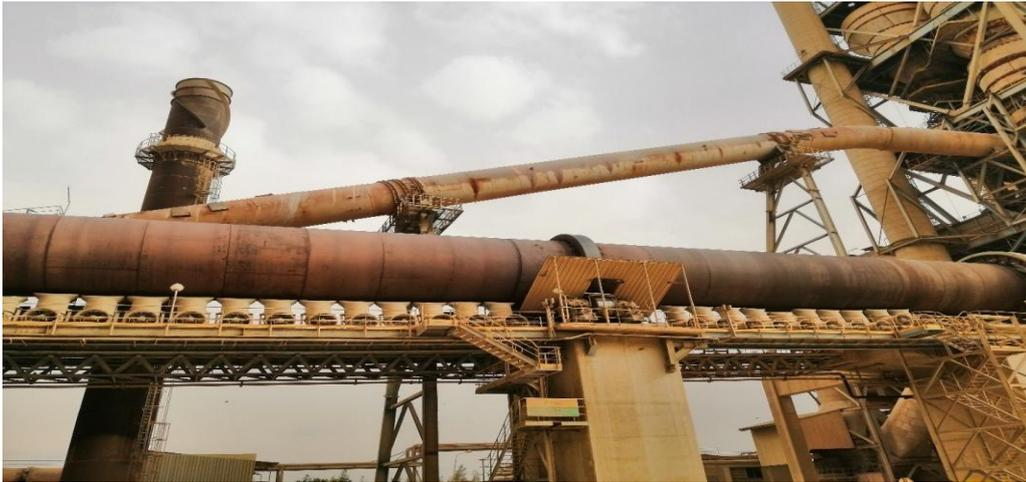
**Figure (III.3) : four rotatif d'usine (LafargeHolcim-Mascara)**
