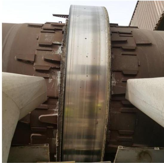
**Figure I.13 : bandage frottant d'un four rotatif**
