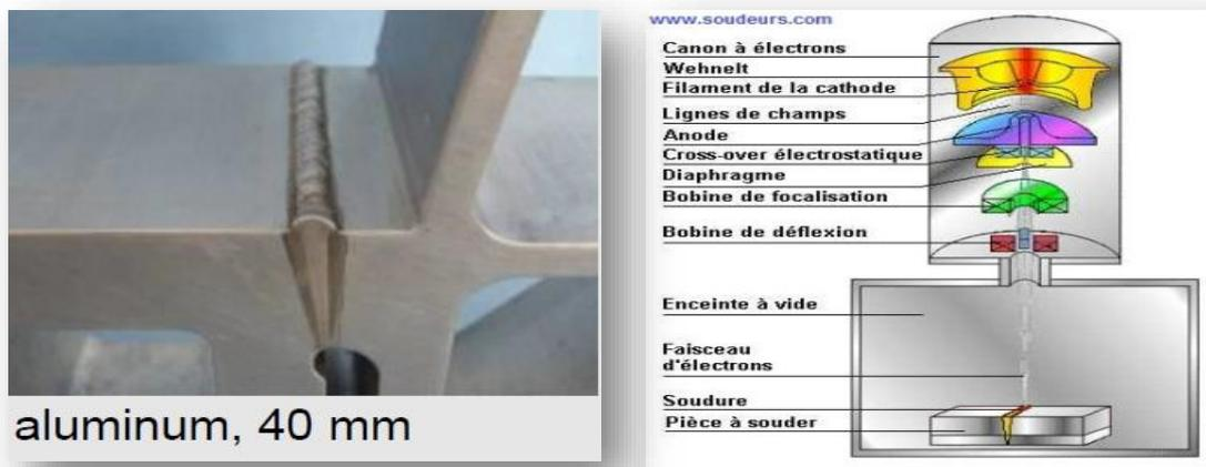
Figure I.11: Soudage par faisceau d'électrons
