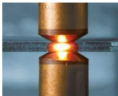
**Figure I.4:** Soudage par résistance
