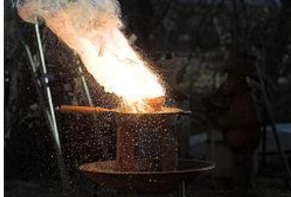
**Figure I.3 :** Soudage aluminothermique
