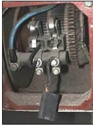
Figure 5 - L'ensemble balais, porte-balais et collecteur
