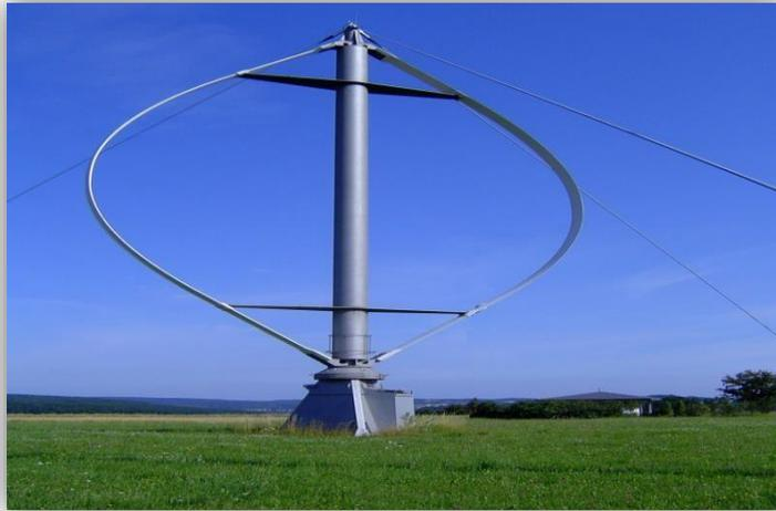
*Figure I.16: Éolienne de type Darrieus.*
