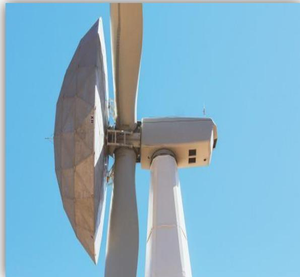
*Figure I.15: Éolienne à cône.*
