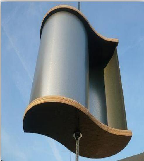
*Figure I.14: Éolienne de type Savonius.*
