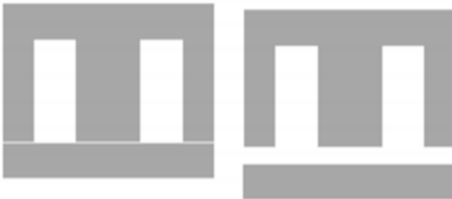
Figure II.7 : Schémas des tôles d'un transformateur monophasé.
