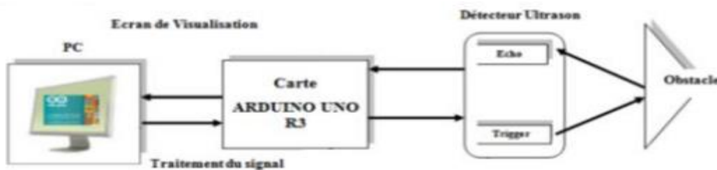
Figure III.1 : Schéma synoptique de notre projet.
