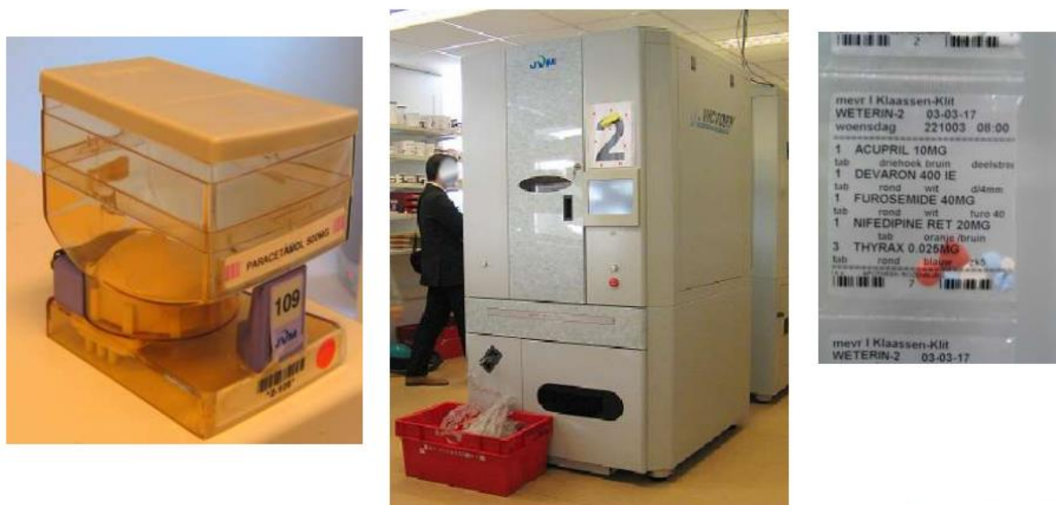
Figure I-10 Préparation de formes orales sèches : Automates SYGIPH (EURAF)[22]
