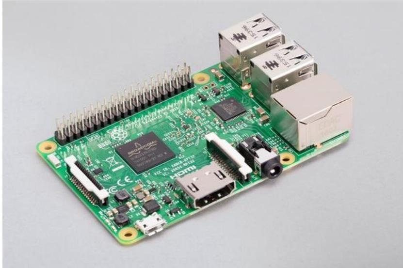
**Fig. II.6 :** Raspberry pi 3 modèle B.
