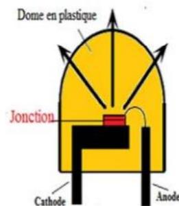
**Figure 1.6 :** Diode Electroluminescente usuelle encapsulée [8]
