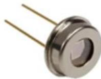
Figure 1.17 : La photodiode [9]
