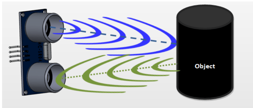
Figure II.8. Fonctionnement du capteur à ultrasons HC-SR04
