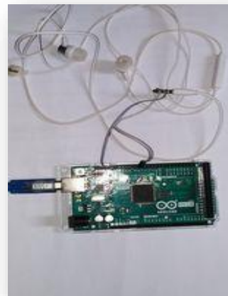
Figure.III.22.Test de l'écouteur avec bibliothèque Talkie d'arduino.
