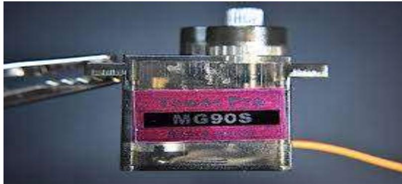
*Figure IV.5 : Servomoteur MG90S.*
