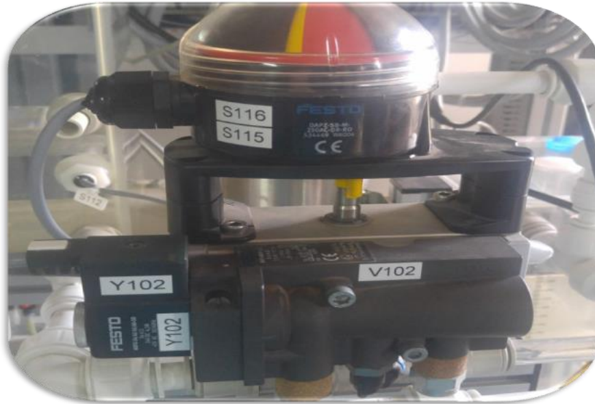
Figure 50: Processus de la vanne à bille
