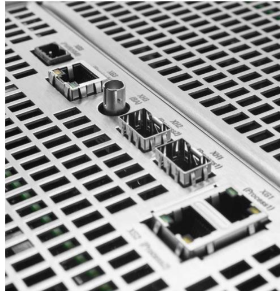
Figure 36 : les interfaces de communication SNTP
