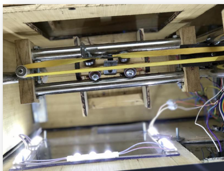
Figure III.62: Photo réelle des LED à l'intérieur du distributeur
