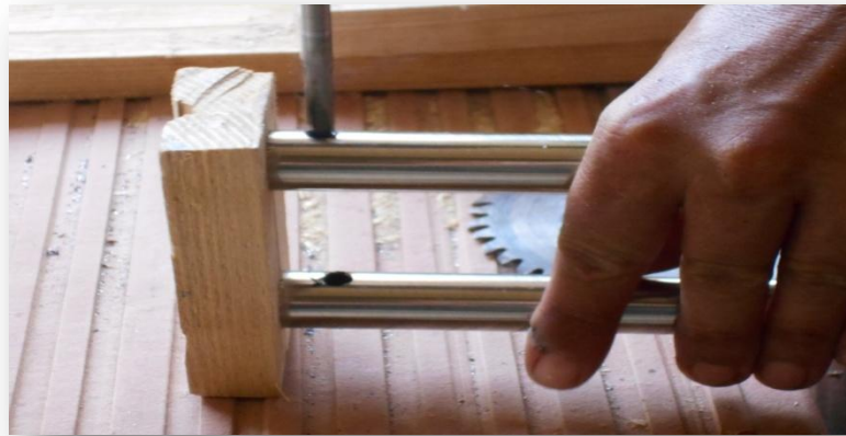
Figure III.44: Photo réelle du perçage des tubes
