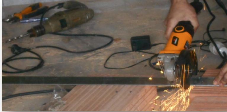
Figure III.37 : Photo réelle du découpe d'une baguette en aluminium
