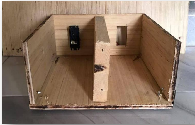
Figure III.55: Photo réelle des cases avec les places des servomoteurs
