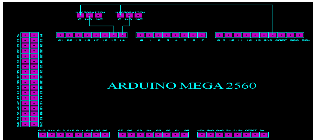
Figure : II.14-Branchement PCB du Micro switch
