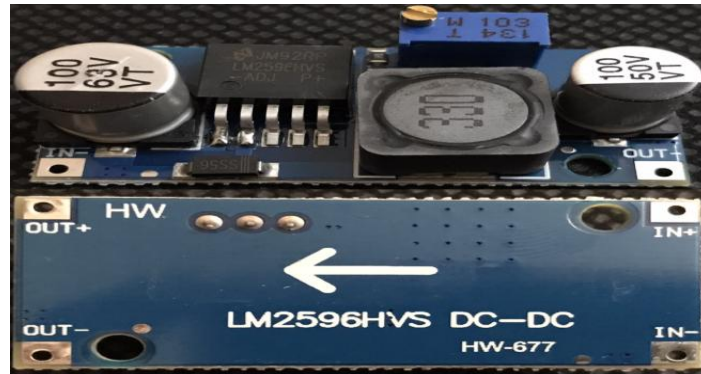
Figure : II.19-Photo réelle du Module d'alimentation abaisseur DC-DC LM2596HVS
