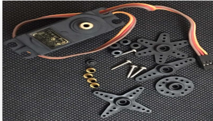
Figure : II.15-Photo réelle du Servomoteur MG995 360 degrés (à rotation continue)
