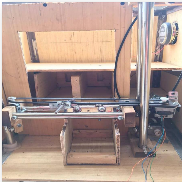
Figure III.52: Photo réelle de l'installation des courroies
