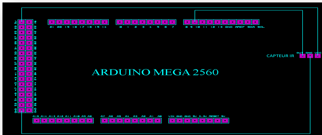
Figure : II.10-Branchement PCB du capteur IR de proximité FC-51
