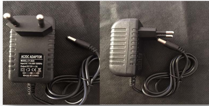
Figure : II.20-Photo réelle du transformateur 12V/2A
