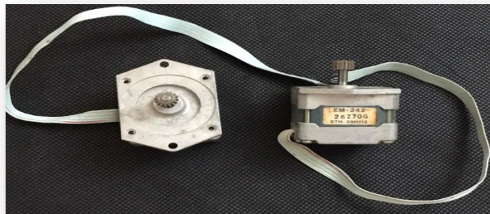
Figure : II.24-Photo réelle du Moteur pas à pas NEMA17
