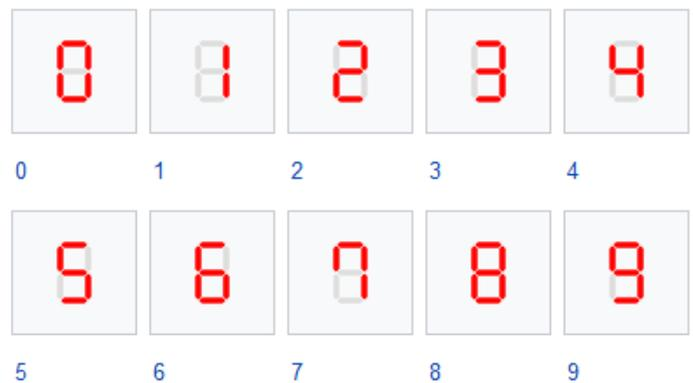
Les chiffres 6, 7 et 9 sont les seuls à pouvoir être représentés de deux façons : En allumant les segments A, C, D, E, F et G ou rarement C, D, E, F et G pour le 6, en allument A, B et C (comme sur ce tableau),
