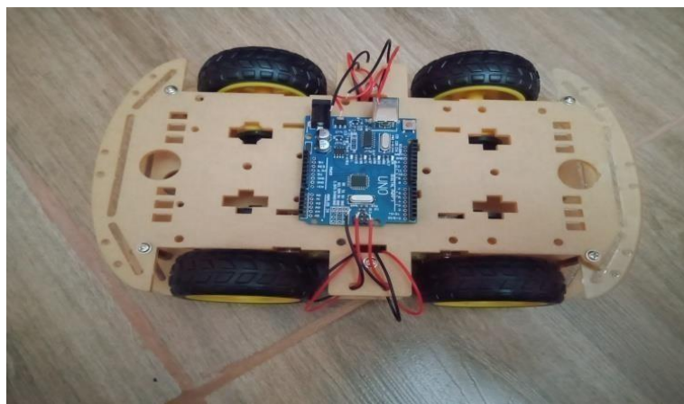
Figure II.15 : Installation la plaque des moteurs sur le châssis
