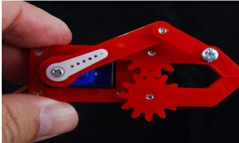
Figure II.21 : Fixation du servomoteur de la pince
