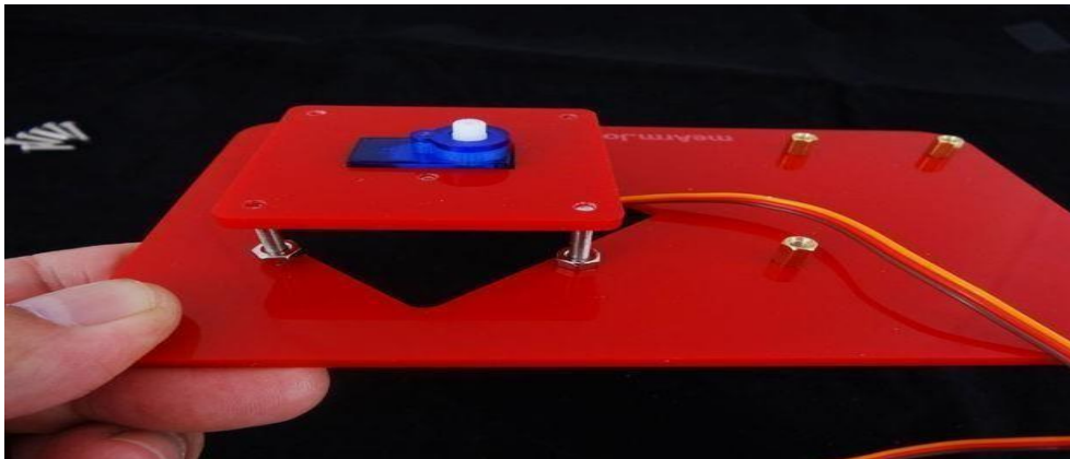
Figure II.19 : La fixation du servomoteur de la base
