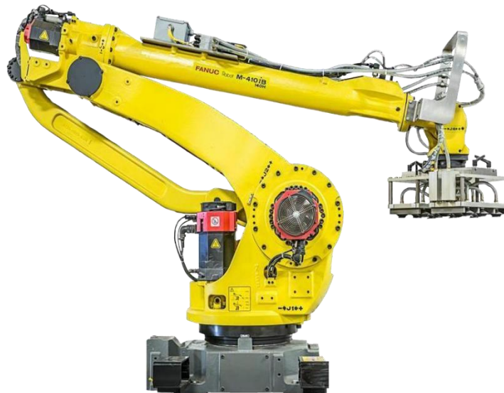
Figure I.25 : La structure 3r (Anthropomorphe)
