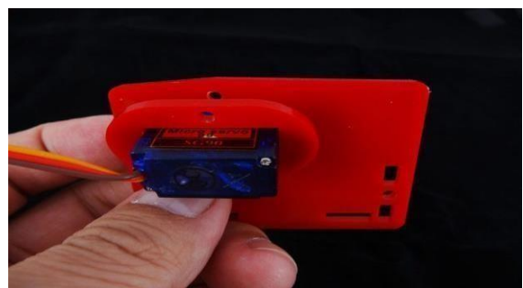
Figure II.20 : Fixation du servomoteur du côté droite et gauche
