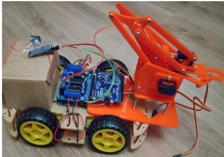
Figure II.23 : Bras manipulateur embarqué sur un robot mobile
