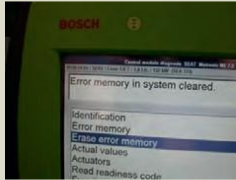
Figure 3.19: Effacer le défaut de la mémoire.
