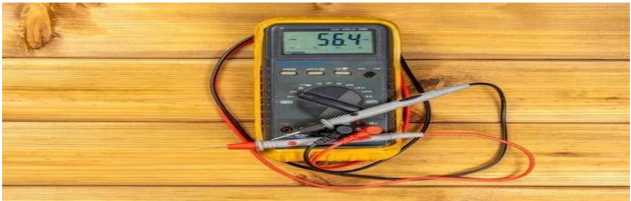
Figure 1.7 : multimètre pour tester un capteur ABS.
