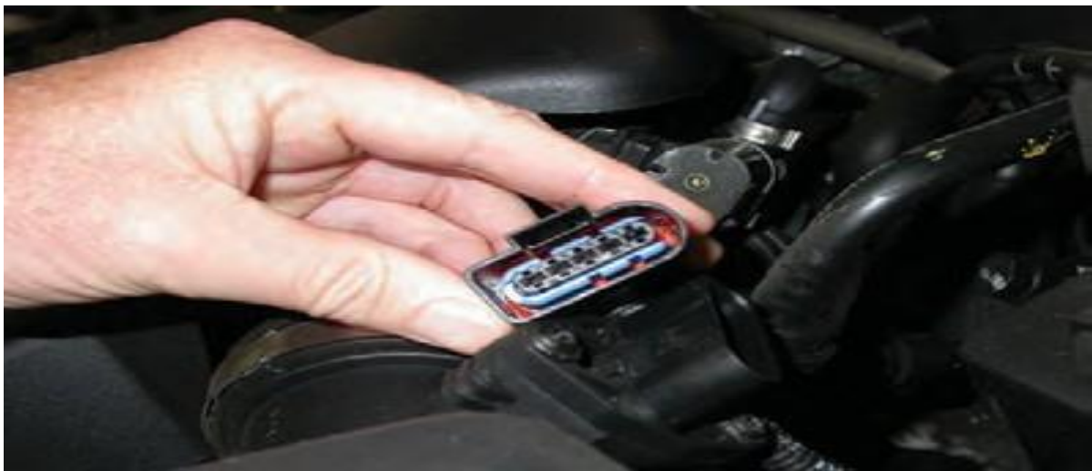
Figure 1.22 : Débitmètre d'air à l'essai.
