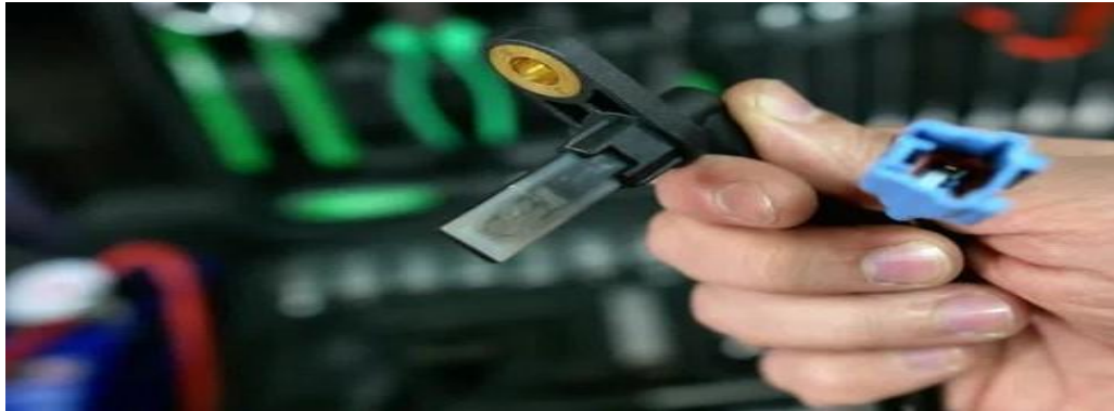
Figure 1.10 : capteur ABS nettoyé.
