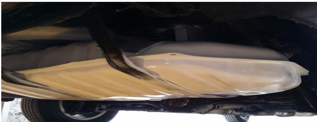
Figure 1.5: réservoir à carburant.
