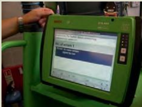
Figure 3.15: Prendre une lecture de la mémoire de l'unité de commande (affichage DTC).
