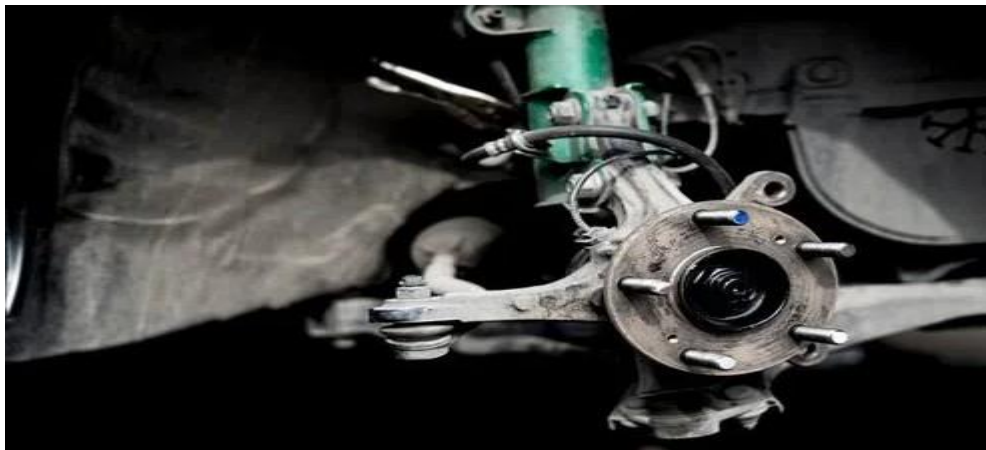
Figure 1.9 : démonter le capteur ABS.
