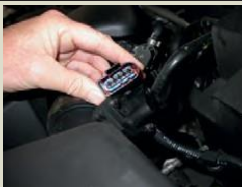
Figure 3.16: Connexion du capteur de débit d'air.
