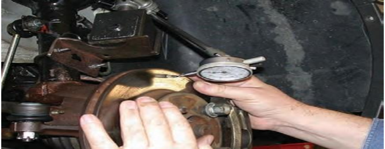
Figure 1.5 : Vérification de l'épuisement du disque de frein à l'aide d'une jauge à cadran.
