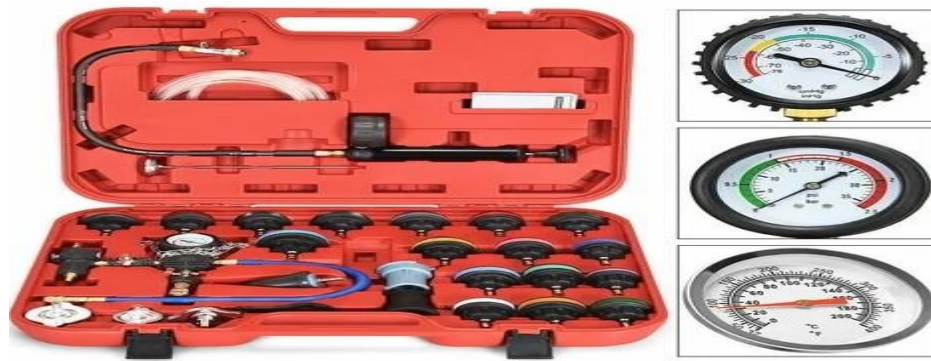
Figure 1.30 : Kit de test du système de refroidissement.
