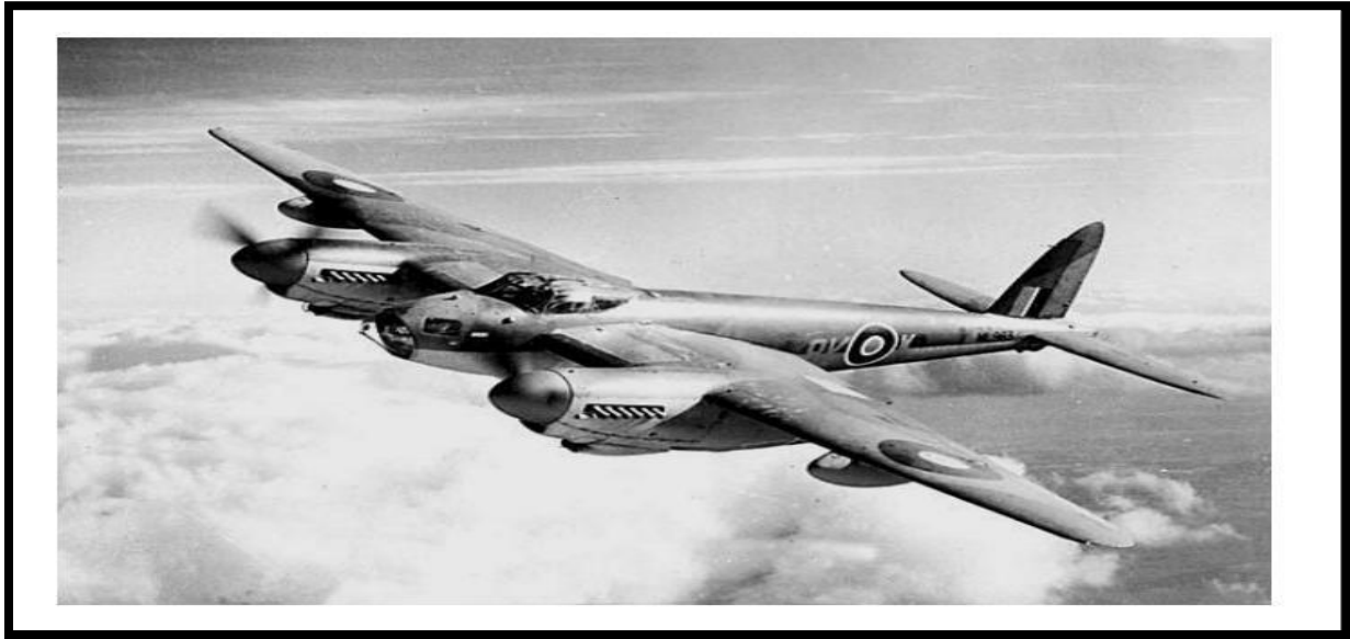
Figure 22 Avion militaire Britannique, Le Mosquito, en structure sandwich.
