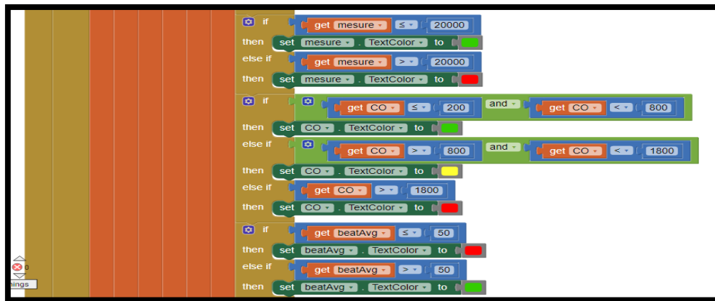
Figure IV.17 Bloc d'affichage des données et des mesures des capteurs (B).
