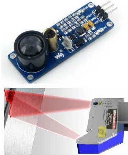
**Figure. III8 :** Un bouclier de capteur laser et sa représentation fonctionnelle.
