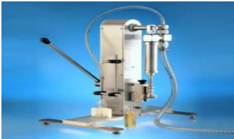
**Figure 1. 3 :** Remplisseuse volumétrique manuelle de la marque COVEN EGIDIO
