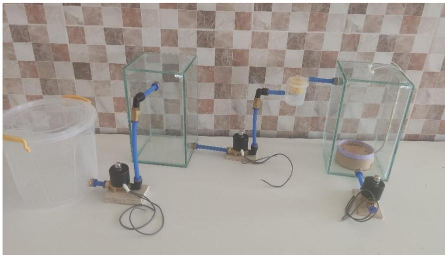
**Figure 3. 20:** système remplissage et filtre
