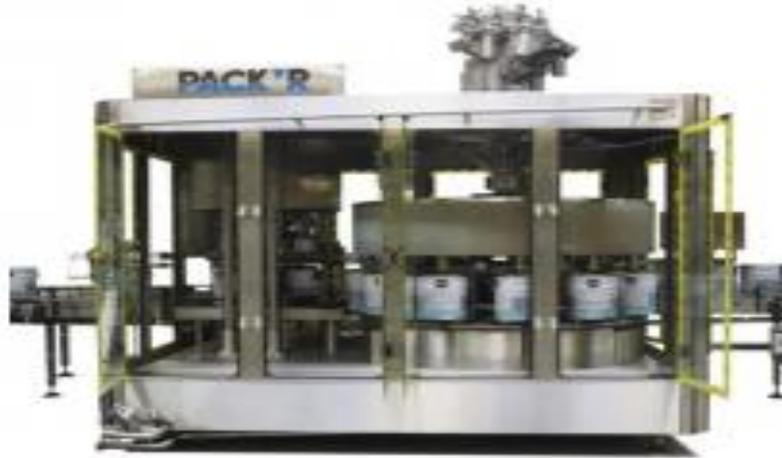
**Figure 1. 5 :** Remplisseuse automatique rotative de la marque PACK'R
