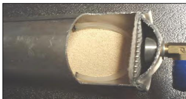
Figure I- 10 billes de zéolithe dans la colonne
