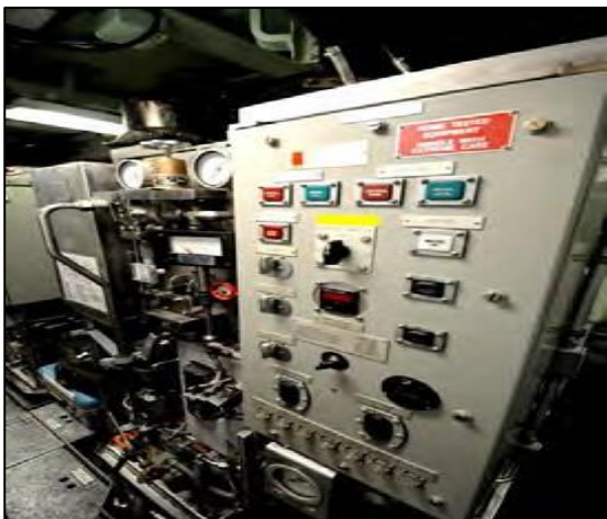
Figure I- 19 : électrolyseur du sous-marin américain
