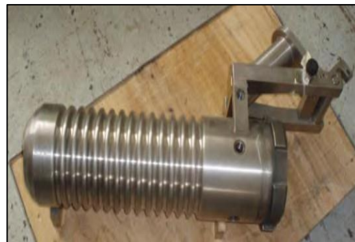
Figure I- 16 Chambre De Réaction
