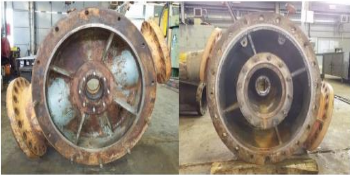
Figure 30. Tubulures d'aspiration et de refoulement.
