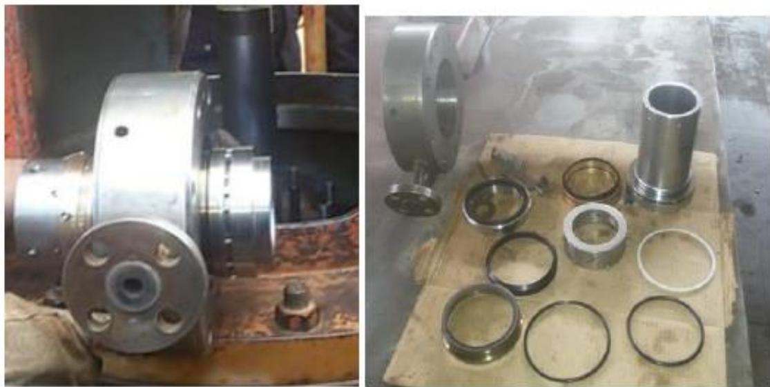
Figure 29. Garniture mécanique de P105.
