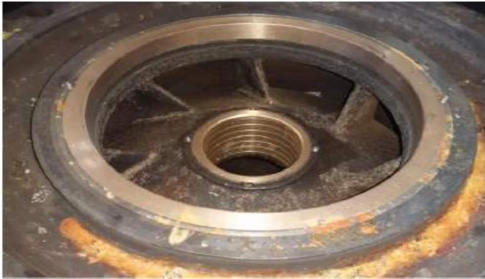
Figure 26. Bague d'usure montée dans son support.
