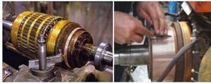
Figure II. 8. Composition de l'induit.
