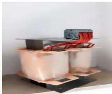
Figure (I.23) : transformateur monophasé
