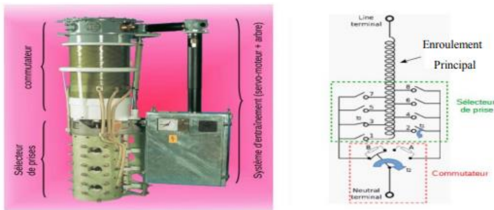
Figure (I.27) : Régleur en charge et Système de commutation
