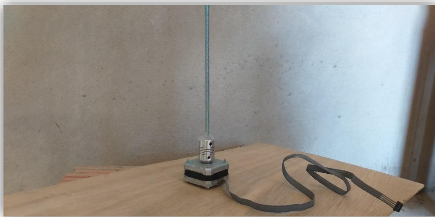
Figure III.31 : Assemblage du moteur et de la tige via un accouplement
