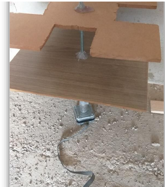
Figure III.33 : Photo réelle du nouveau corps (moteur + accouplement +tige +support +récipient)
