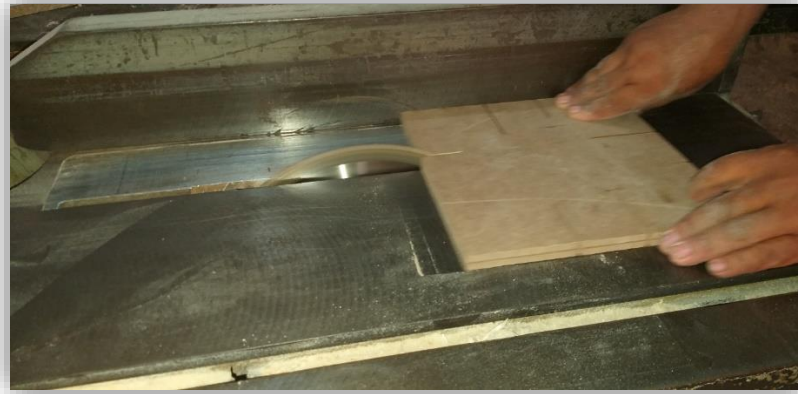
Figure III.24 : la découpe du bois utilisant la machine de bois combiné
