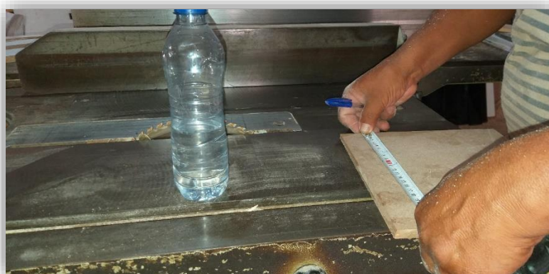
Figure III.23 : Prendre des mesures exactes pour couper le récipient
