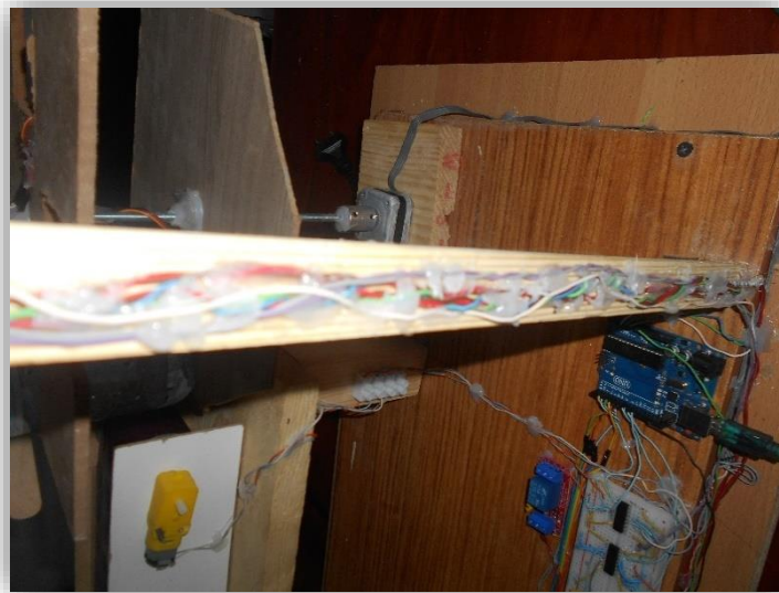
Figure III.55 : Vue A du branchement de la carte Arduino avec les composants
