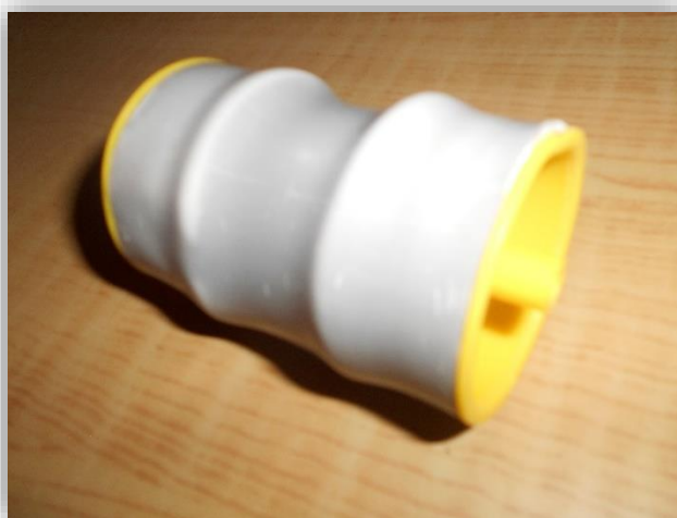
Figure III.9 : Résultat final de l'insertion de la roue à l'intérieur du tube PVC
