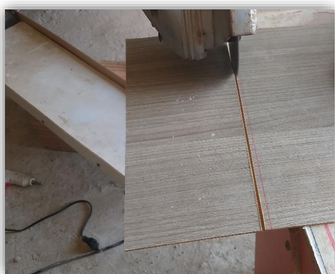
Figure III.22 : la découpe du support
