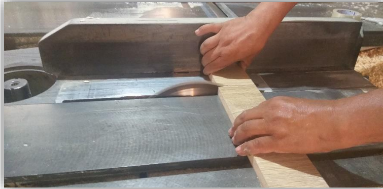
Figure III.2 : Photo réelle de la découpe du 2eme morceau de bois
