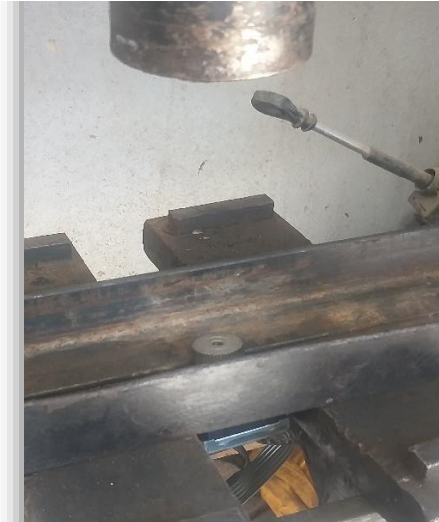
Figure III.30 : L'enlèvement du pignon du moteur
