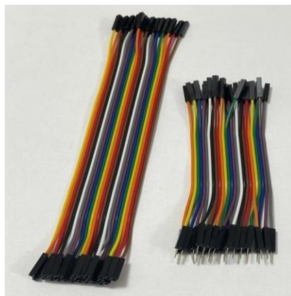
Figure 3-15 : Câbles de liaisons
