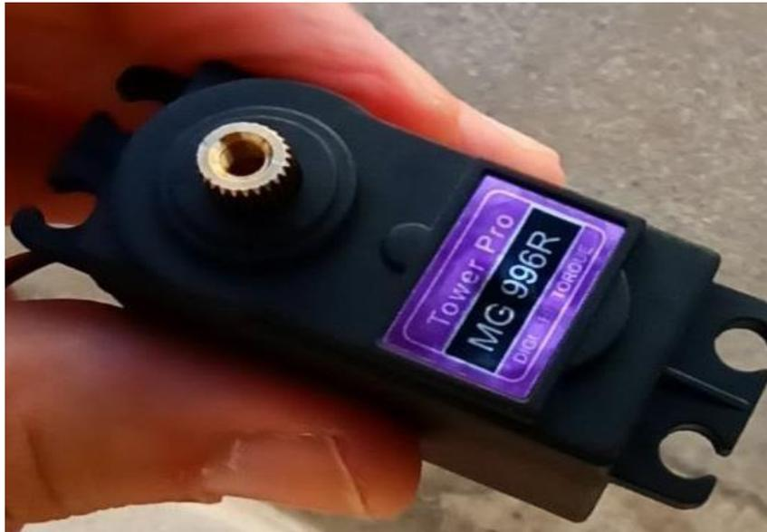
**Figure IV. 9** : Servomoteur MG6600R
