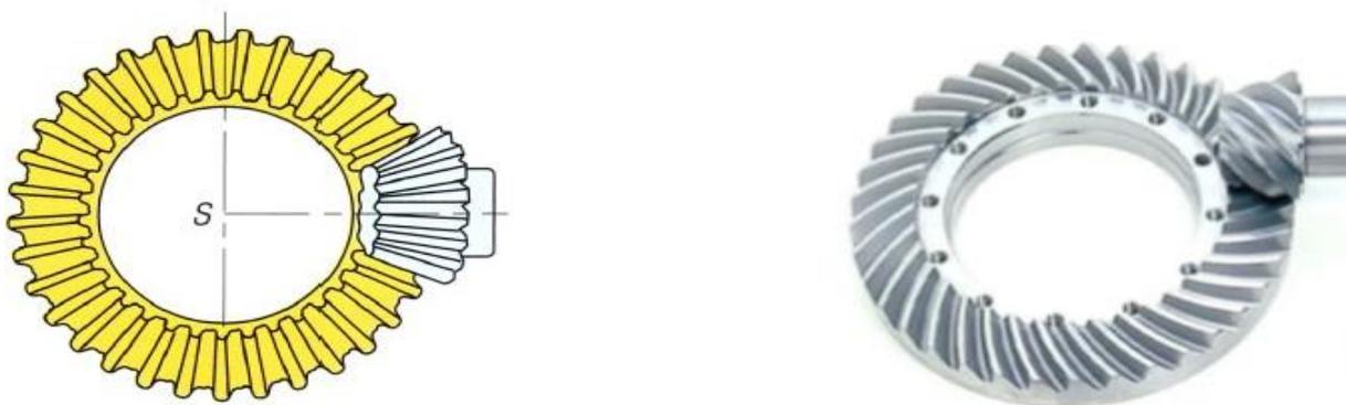
Figure 1.4 : engrenages à axes concourants
