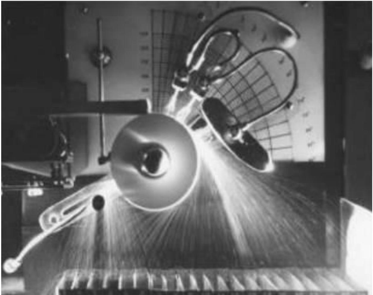
**Figure I-12** : Trajectoire réel des particules dans un séparateur a cylindre tournant[14]
