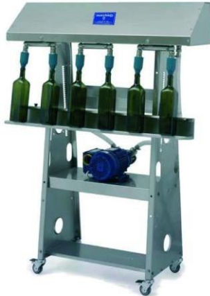
Figure1.1. Remplisseuse pour l'huile
