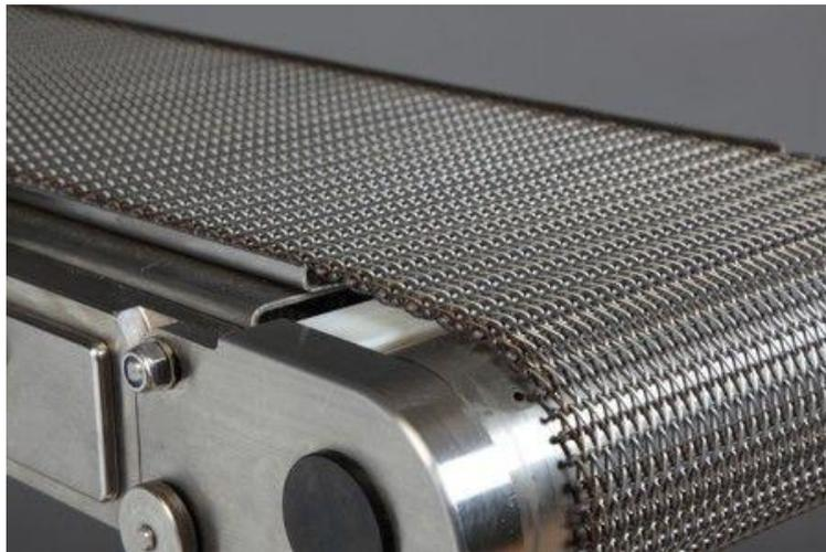
**Figure 1.11** Convoyeur à bande métallique. [24]
