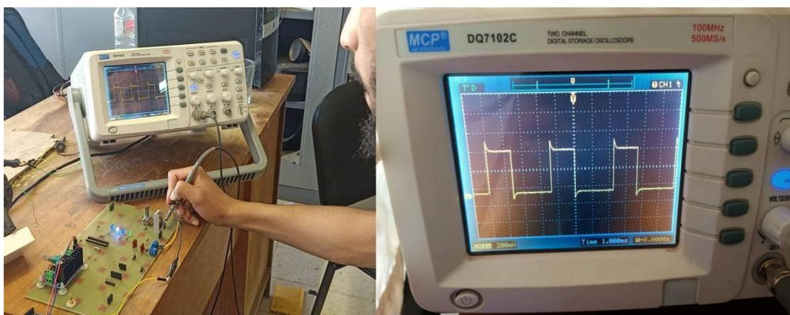
**Figure 4.27** Test de circuit PWM à travers l'oscilloscope.
