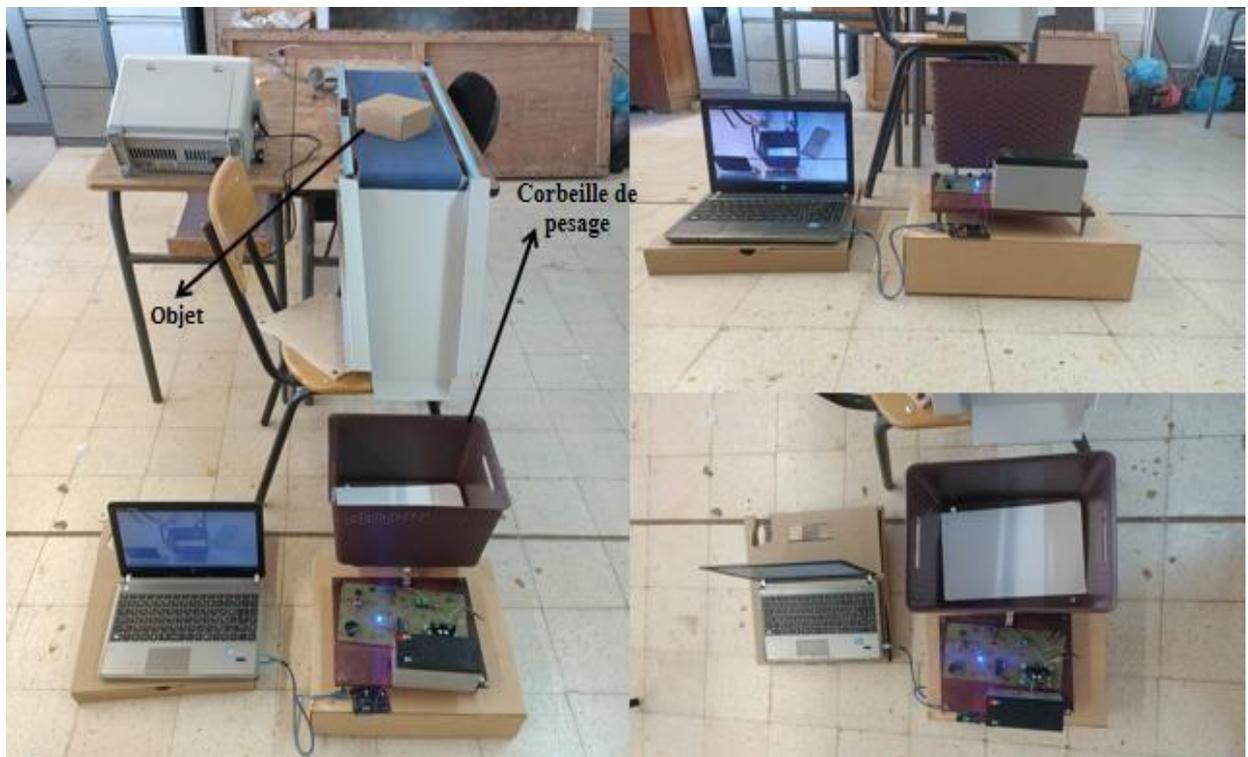
**Figure 4.39** pesage des objets transporté par le tapis Convoyeur.
