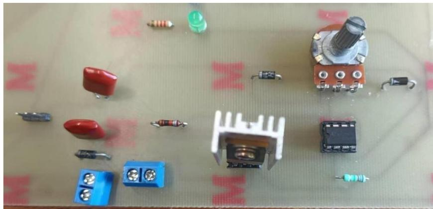
**Figure 4.26** Circuit PWM dans la carte PCB.
