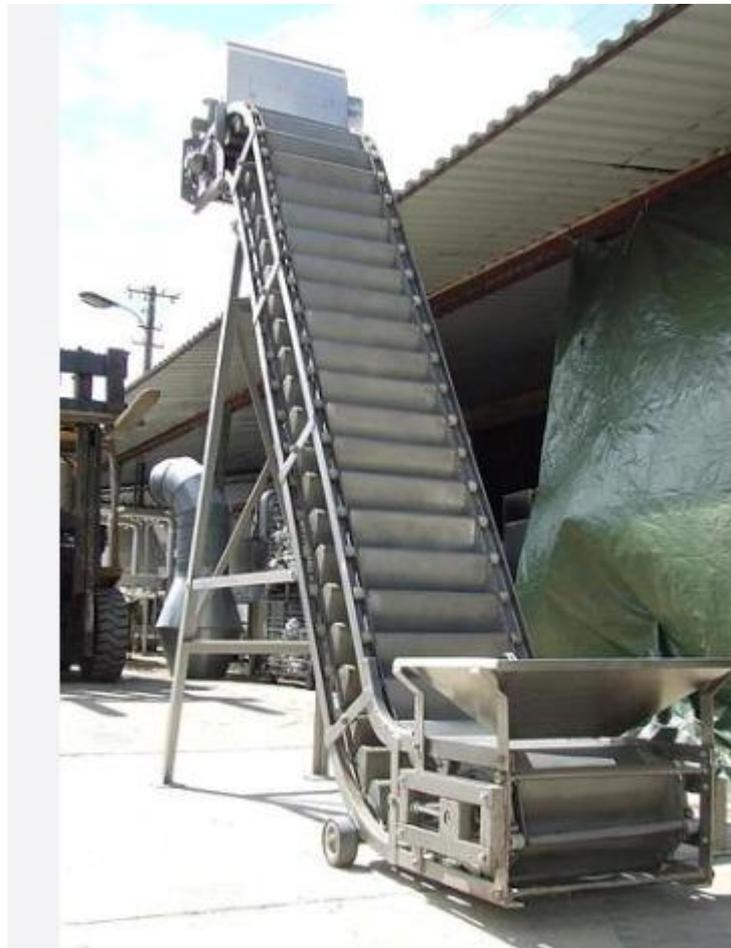
**Figure 1.4** Convoyeur à godet [11]
