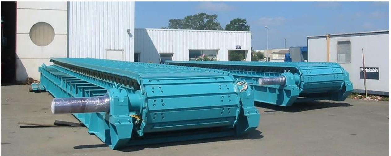
**Figure 1.5** Convoyeur alimentateur à tablier métallique (ATM) [13]
