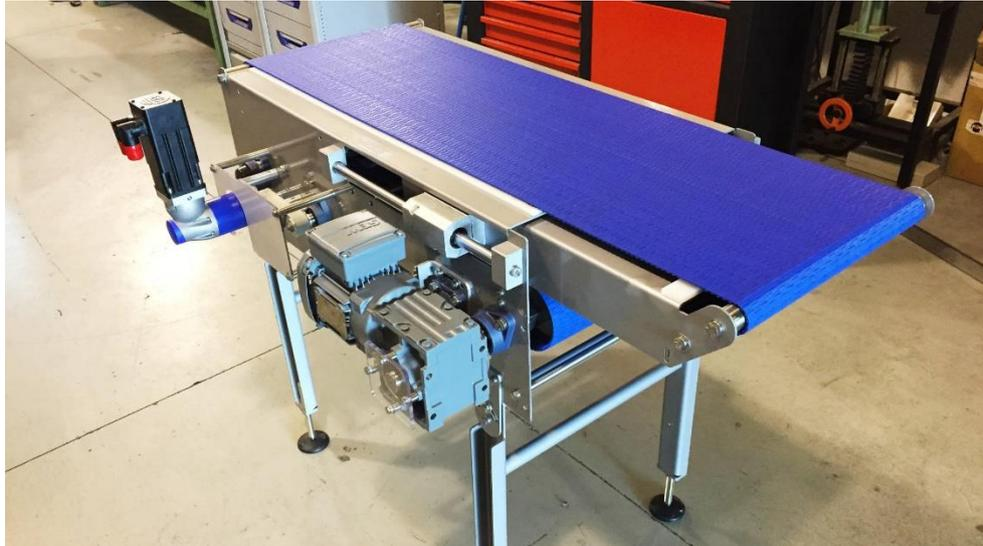
**Figure 1.12** Convoyeur à bande textile.
