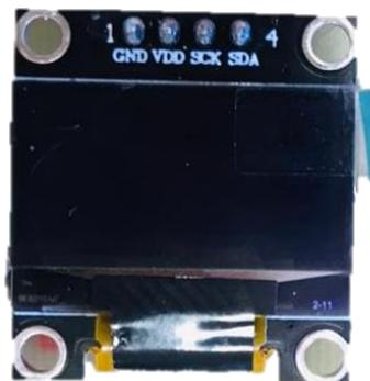
**Figure 2.12** Afficheur OLED.
