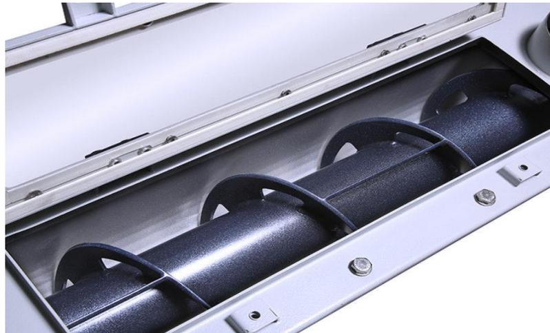
**Figure 1.3** Convoyeur a vis sans fin [9]
