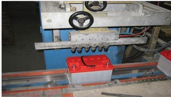
Figure II.12: Aperçu du test d'étanchéité.
