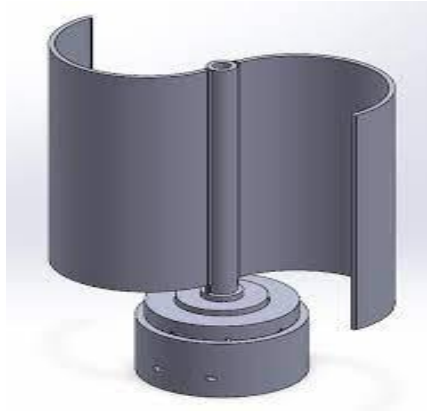
Figure 1.2 Éolienne à axe vertical (Modèle Savonius)
