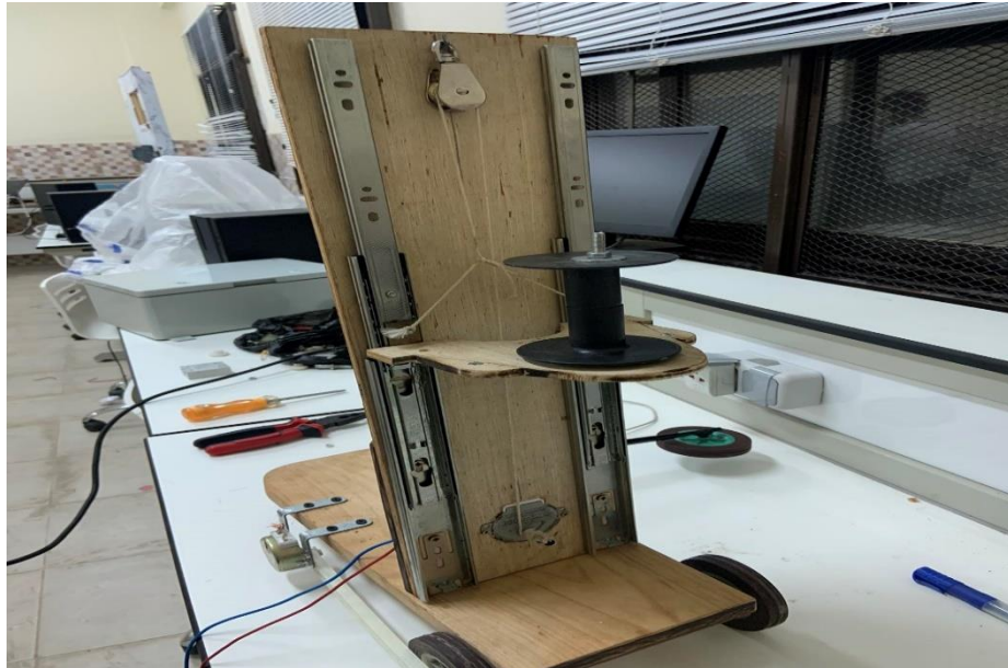
Figure IV.7 : Transmission du mouvement par glissière
